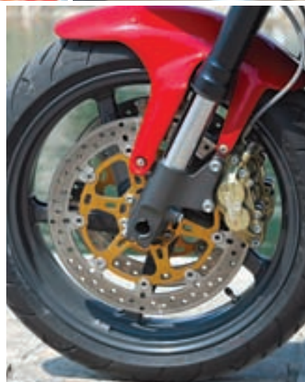
Prednji kočioni sustav Brembo sa dvostrukim plivajućim diskovima promjera 320 mm na koje djeluju čeljusti sa 4 klipci
