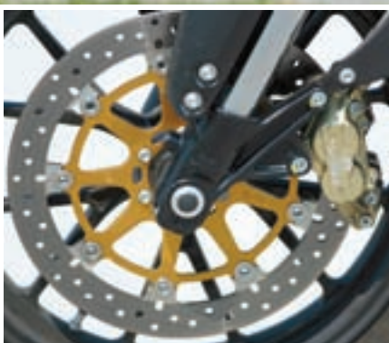
Disk promjera 320 mm na koji djeluju Brembo četveroklipna kočiona klješta
