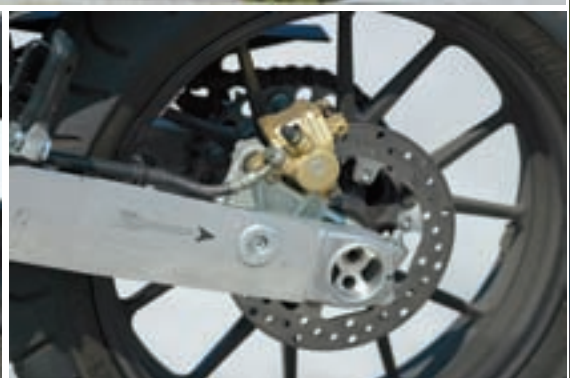
Aluminijska vilica novog poprečnog presjeka s vanjskim ojačanjem radi povećanja krutosti
