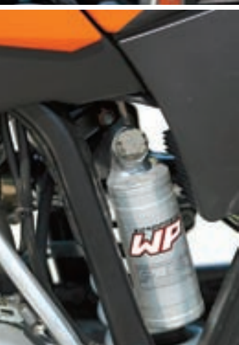
Hidraulika stražnjeg amortizera lako se podešava, što se baš i ne bi moglo reći za podešavanje opterećenja opruge pomoću teško dostupnih navojnih prstena
