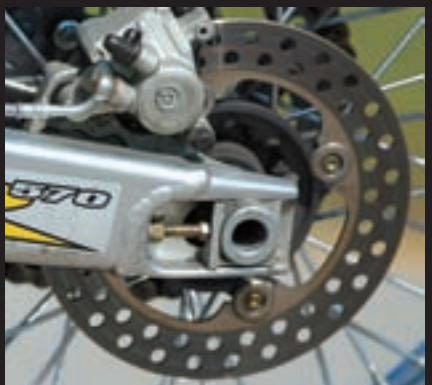
Jednoklipna kočiona klješta Brembo i stražnji disk promjera 220 mm koji je neuobičajenog plivajućeg tipa
