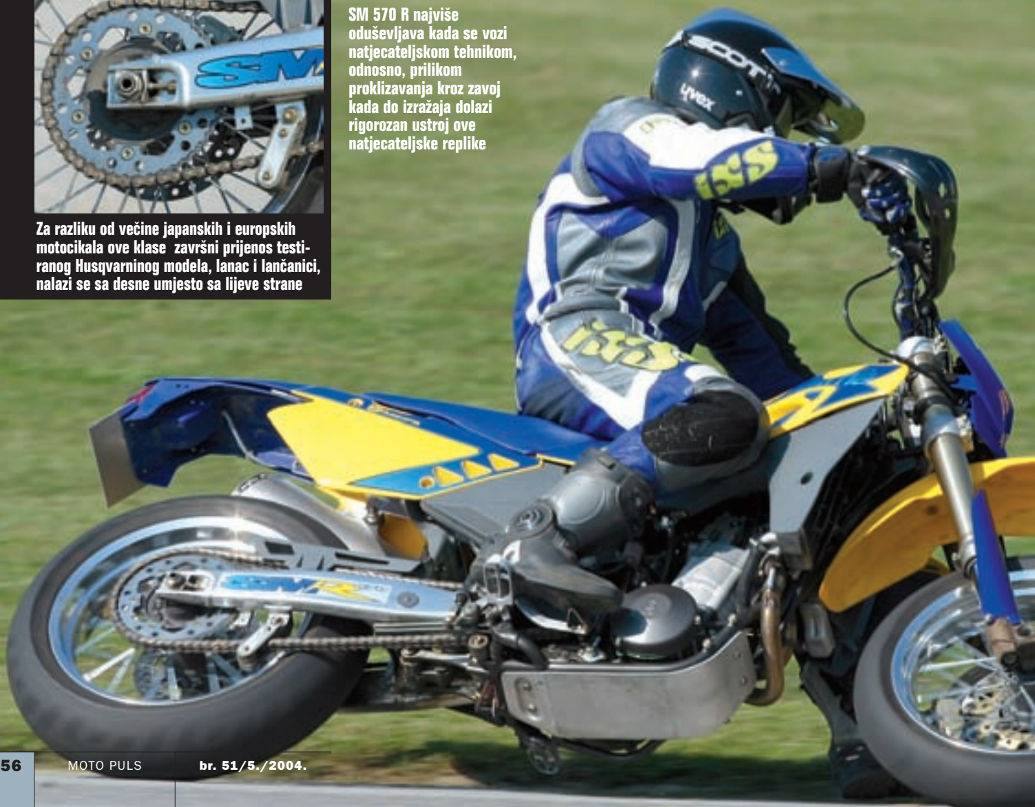
Jednoklipna kočiona klješta Brembo i stražnji disk promjera 220 mm koji je neuobičajenog plivajućeg tipa
