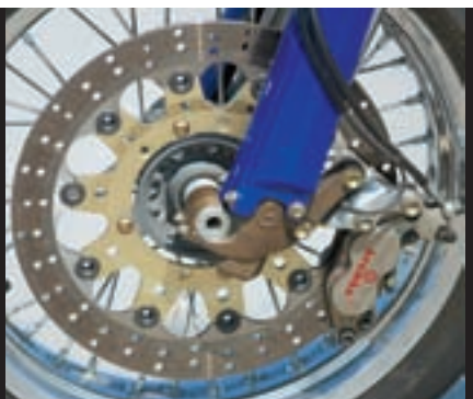
Plivajući disk promjera 320 mm na koji djeluju Brembo četveroklipna kočiona klješta
