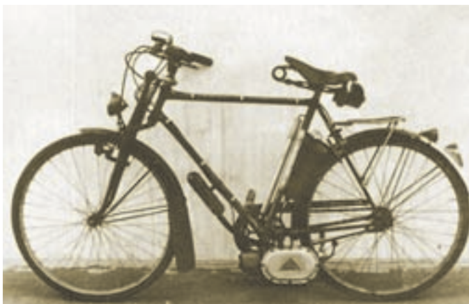
Lohman dizel motor bio je tako malen da se na biciklu nije ni primijetio. Sa samo litrom goriva moglo se prijeći više od 100 km
