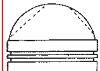
Kupolasto „bombato“, čelo klipa - natjecateljski motori 1950-tih, 1960-tih i 1970-tih godina
