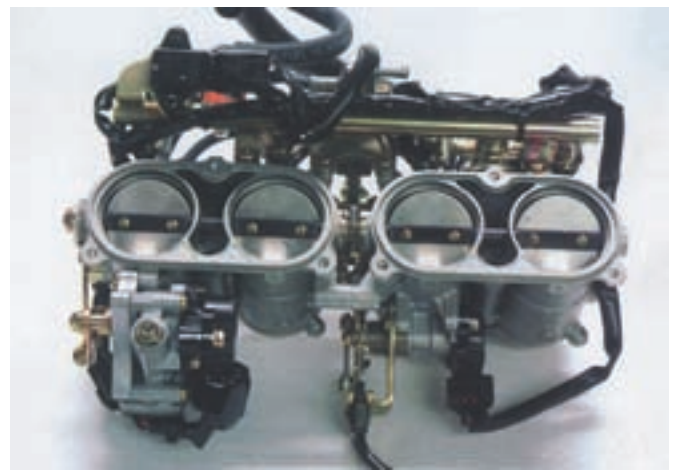
Tijela leptira Mikuni, promjera 45 mm funkcionirat će korespondencijom sa novim centralnim računalom i samo po sebi nisu pretrpjela modifikacije
