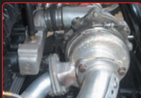
Turbo sa usisnom granom nalazi se na mjestu rasplinjača
