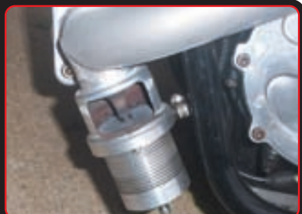
Tlačni ventil ugrađen u ispušnu granu
