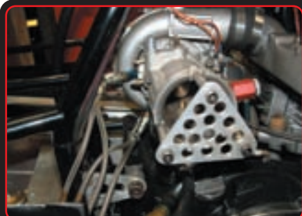
Metalna ploča sprečava usisavanje malene djece i kućnih ljubimaca
