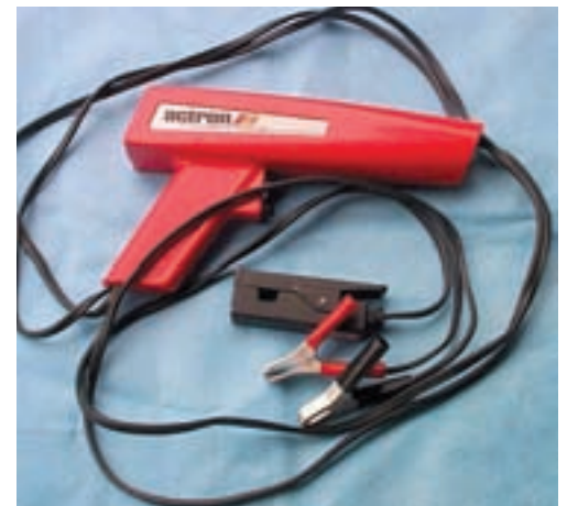
Stroboskopski pištolj za provjeru točke paljenja
