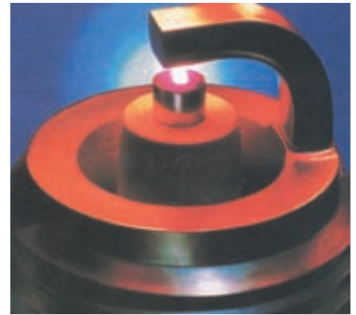
U trenutku "skakanja" iskre između elektroda svjeće počinje paljenje smjese koje traje nekoliko milisekundi. Upravo toliko treba klipu da dođe do GMT, zbog čega je predpaljenje i potrebno
