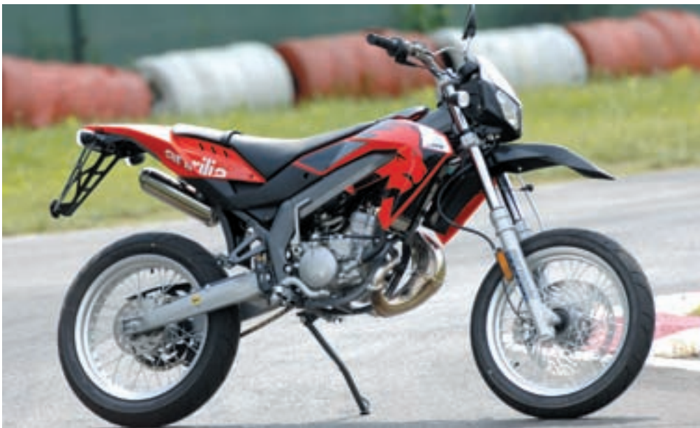
Disk promjera 300 mm s dvoklipnim kļeštima djeluje moćno i uljeva povjerenje
