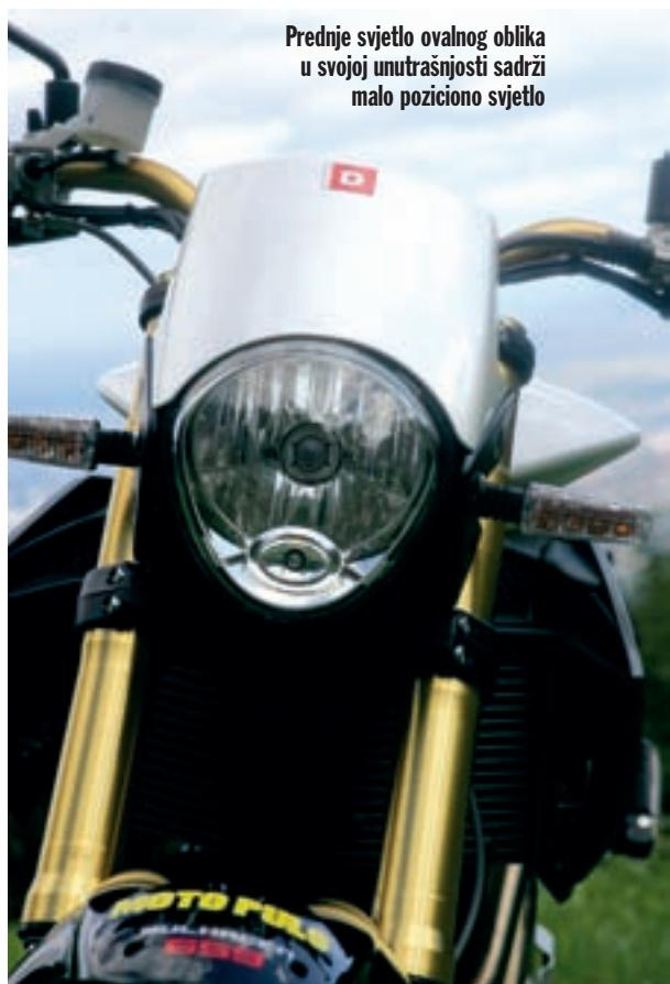
Prednje svjetlo ovalnog oblika u svojoj unutrašnjosti sadrži malo pozicionirano svjetlo
