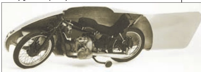
Još jedan primjerak iz 1937., no ovaj put je to BMW-dvocilindrični boxer agregat od 70 KS. Ostvario je maksimalnu brzinu od 279,5 km/h. Bez kupole presjek aerodinamičkog oklopa doima se poput prerezane ribe kod koje dominira ogroman rep. Višestruki rekorder W. Henne nekoliko je godina uzastopce osvajao rekorde BMW-om
