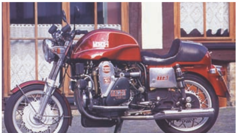
Mammuth 1.600 TTS s EGLI-ovom prednjom vilicom i karakterističnim rezervoarom u kojeg je stalo tek 15 l. goriva. Ovaj model bio je opremljen mehaničkim ubrizgavanjem goriva tipa "Kugelfischer"
