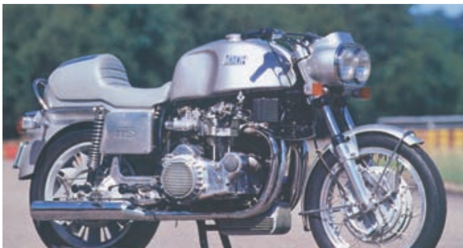
Munch Mammuth s motorom NSU-PRINZ 1200 TTS, poznat iz automobilske industrije, šezdesetih je godina bio najbrži cestovni motocikl na svijetu. Robusna i čvrsta konstrukcija davala je do znanja da proizvod dolazi iz Njemačke
