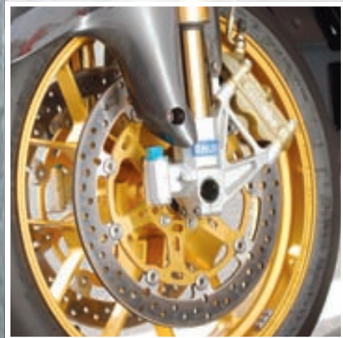
Ohlinsova vilica u kombinaciji s Brembovim kočionim sustavom i kotačima od kovanog aluminija. Ekskluziva na sve strane
