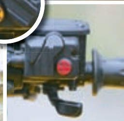
► Uz desnu ručku se smjestila tipka za uključivanje pogona na četiri kotača, a ispod svojevrsnog osigurača je i tipka za blokadu diferencijala
