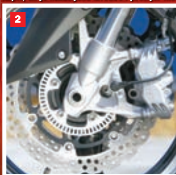
(1) Pogonski agregat je mijenjan radi ostvarivanja više momenta na niskim i srednjim okretajima. Iako bi netko mogao poželjeti više brutalnosti na visokim okretajima, redni četvociлиндраш заслужује visoku ocjenu zbog impresivne elastičnosti (2) Nazubljeni prednji diskovi promjera 300 mm odlično obavljaju svoj posao. Radijalna kočiona klijesta polako ulaze i u ovu klasu, a za potpuni doživljaj tu je i radijalna pumpa (3) Stražnji disk ima samo jedan klipčić, ali je nazubljene izvedbe i promjer mu je povećan na 250 mm
