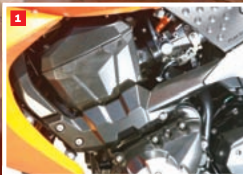
(1) Pogonski agregat je mijenjan radi ostvarivanja više momenta na niskim i srednjim okretajima. Iako bi netko mogao poželjeti više brutalnosti na visokim okretajima, redni četvociлиндраш заслужује visoku ocjenu zbog impresivne elastičnosti (2) Nazubljeni prednji diskovi promjera 300 mm odlično obavljaju svoj posao. Radijalna kočiona klijesta polako ulaze i u ovu klasu, a za potpuni doživljaj tu je i radijalna pumpa (3) Stražnji disk ima samo jedan klipčić, ali je nazubljene izvedbe i promjer mu je povećan na 250 mm
