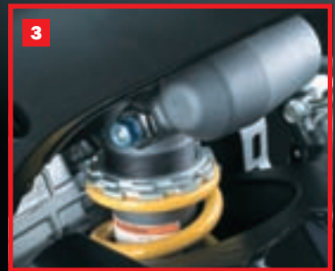
(1) Podesivi oslonci za noge (2) Ispušni ventil optimizira rad ispušnog sustava u niskim okretajima (3) Novi stražnji amortizer sada uz podešavanje tvrdoće opruge i povrata ima mogućnost regulacije brze i spore kompresije
