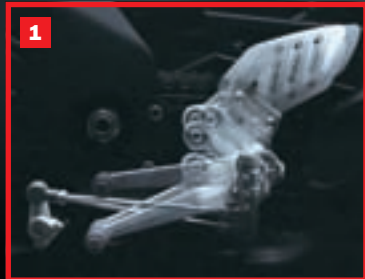
(1) Podesivi oslonci za noge (2) Ispušni ventil optimizira rad ispušnog sustava u niskim okretajima (3) Novi stražnji amortizer sada uz podešavanje tvrdoće opruge i povrata ima mogućnost regulacije brze i spore kompresije
