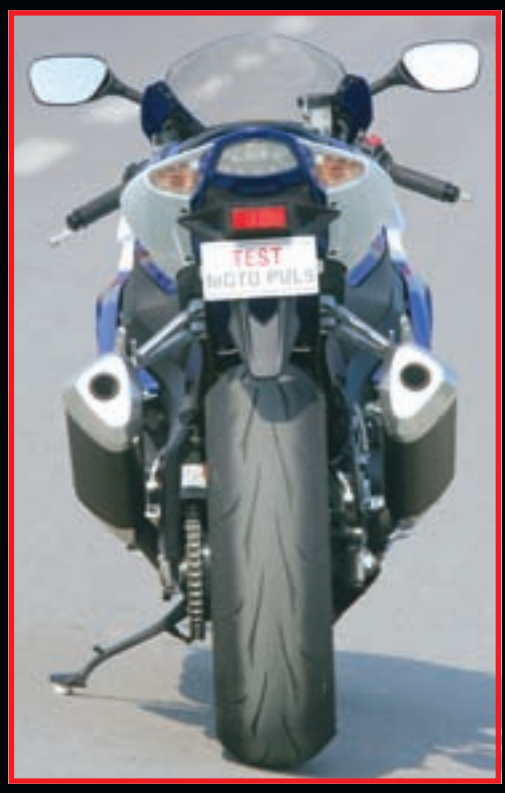
▶ Za razliku od konkurencije, Suzuki nije odlučio smjestiti ispušne topove ispod sjedišta suvozača
