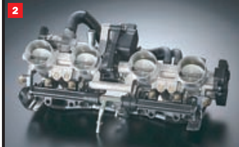
(1) Možda najveći napredak postigle su kočnice, za koje imamo samo riječi pohvale (2) Novi agregat ima i elektronsko ubrizgavanje goriva (3) Novi Banditov pogonski agregat, odsad hlađen tekućinom i sedam konjskih snaga jači
