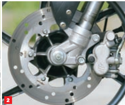
(1) Ploča s vozačkim instrumentima sadrži sve potrebne informacije, uključujući i pokazivač preostale količine goriva. Jedino malo smeta što se brzina može očitati i na digitalnom displeju i na analognom brzinomjeru. Obrtomjer bi bio primjereniji (2) Disk promjera 190 mm posjeduje sasvim zadovoljavajuću zaustavnu snagu (3) Odabir pogonskog agregata Piaggio pokazao se kao sigurno i pouzdano rješenje
