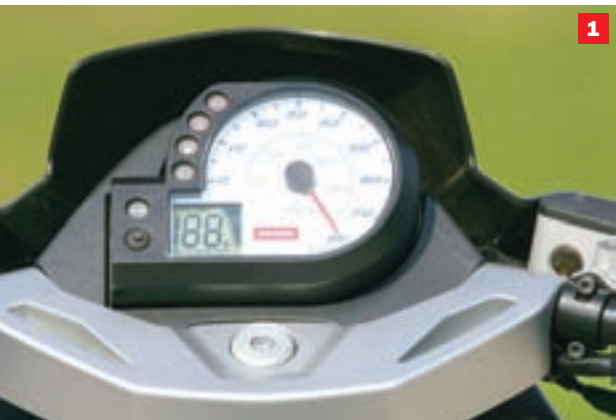
(1) Ploča s vozačkim instrumentima sadrži sve potrebne informacije, uključujući i pokazivač preostale količine goriva. Jedino malo smeta što se brzina može očitati i na digitalnom displeju i na analognom brzinomjeru. Obrtomjer bi bio primjereniji (2) Disk promjera 190 mm posjeduje sasvim zadovoljavajuću zaustavnu snagu (3) Odabir pogonskog agregata Piaggio pokazao se kao sigurno i pouzdano rješenje
