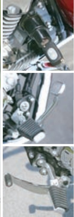
◀ Dok je kontakt bravica smještena lijevo ispod sjedala, ključ koji u nju pripada više bi pristajao nekom skuteru nego motociklu sa obiljem kroma. Nožni oslonci su pomaknuti prema naprijed i učvršćeni na gumene nosače, kako bi se izolirale vibracije
