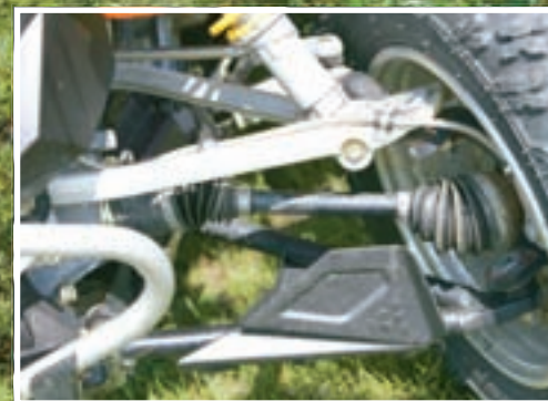
Prednje poluosovine otkrivaju da se radi o vozilu s pogonom ne sve kotače. Tu je i Visco-Lok diferencijal koji, kada detektira proklizavanje, snagu preusmjerava na kotač koji ima bolji kontaktom s podlogom
