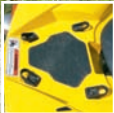
S obzirom na to da ispod sjedala nema mjesta, maleni prtljajni prostor, u kojem se nalazi i alat, smješten je u stražnjem dijelu četverocikla. Do njega se dolazi tako da se otkaci stražnje svjetlo
