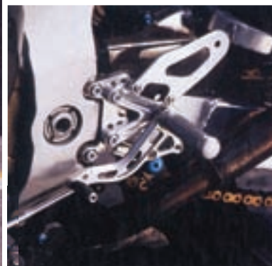
Spremnik goriva i nožne komande od titana gotovo su standardni materijali natjecateljskih motocikala
