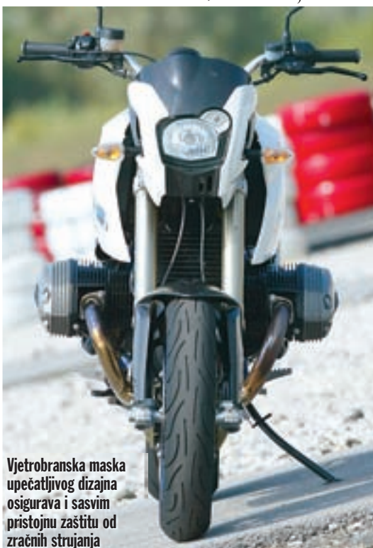
Osim što pridonosi agresivnijoj optici cijelog motocikla, Akrapovičev ispušni sustav zaslužan je i za povećanje ukupne snage
