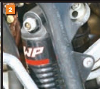
(1) Profesionalni elementi prednjeg kočionog sustava proizvod su tvrtke Brembo, a stručnjaci KTM-ovog natjecateljskog odjela ugradili su i veliki karbonski "usisnik" koji bi trebao smanjiti temperaturu diska i čeljusti prilikom ekstremne primjene (2) WP racing elementi ovjesa na stazi rade besprijekorno. U boksu kao da su potpuno nepokretni, dok u vožnji rade poput Singerice i vozaču pružaju osjećaj potpune sigurnosti i kontrole (3) Stražnja konstrukcija okvira na kojoj se nalazi ekscentar za promjenu visine stražnjeg kraja, čime se utječe i na ukupnu geometriju motocikla, kao i na vrijednost međuosovinskog razmaka (4) CNC trokuti glodani iz jednog komada i sustav za regulaciju geometrije prednje vilice sa 7 međupoložaja
