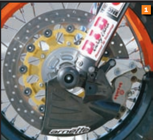
(1) Profesionalni elementi prednjeg kočionog sustava proizvod su tvrtke Brembo, a stručnjaci KTM-ovog natjecateljskog odjela ugradili su i veliki karbonski "usisnik" koji bi trebao smanjiti temperaturu diska i čeljusti prilikom ekstremne primjene (2) WP racing elementi ovjesa na stazi rade besprijekorno. U boksu kao da su potpuno nepokretni, dok u vožnji rade poput Singerice i vozaču pružaju osjećaj potpune sigurnosti i kontrole (3) Stražnja konstrukcija okvira na kojoj se nalazi ekscentar za promjenu visine stražnjeg kraja, čime se utječe i na ukupnu geometriju motocikla, kao i na vrijednost međuosovinskog razmaka (4) CNC trokuti glodani iz jednog komada i sustav za regulaciju geometrije prednje vilice sa 7 međupoložaja
