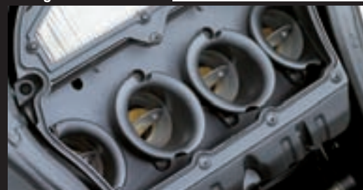
▶ Ovdje vidimo veliki otvor za prihvatanje svježeg zraka u zračnu kutiju te smještaj sekundarnih injektora na njoj, kao i ovalne usisnike zraka, od kojih su duži za drugi i treći cilindar ▼ Usisna tijela sada su ovalnog oblika
