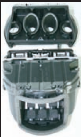
▶ Ovdje vidimo veliki otvor za prihvatanje svježeg zraka u zračnu kutiju te smještaj sekundarnih injektora na njoj, kao i ovalne usisnike zraka, od kojih su duži za drugi i treći cilindar ▼ Usisna tijela sada su ovalnog oblika
