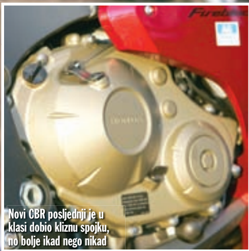
◀ Da nema poklopca pogonskog lanca, bilo bi vrlo lako okrenuti mjenjač tako da je prva brzina gore, a ostale dolje
