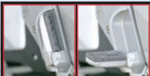
Nogari za suvozača su sklopivi, a pružaju očekivanu razinu udobnosti te ne prenose vibracije
