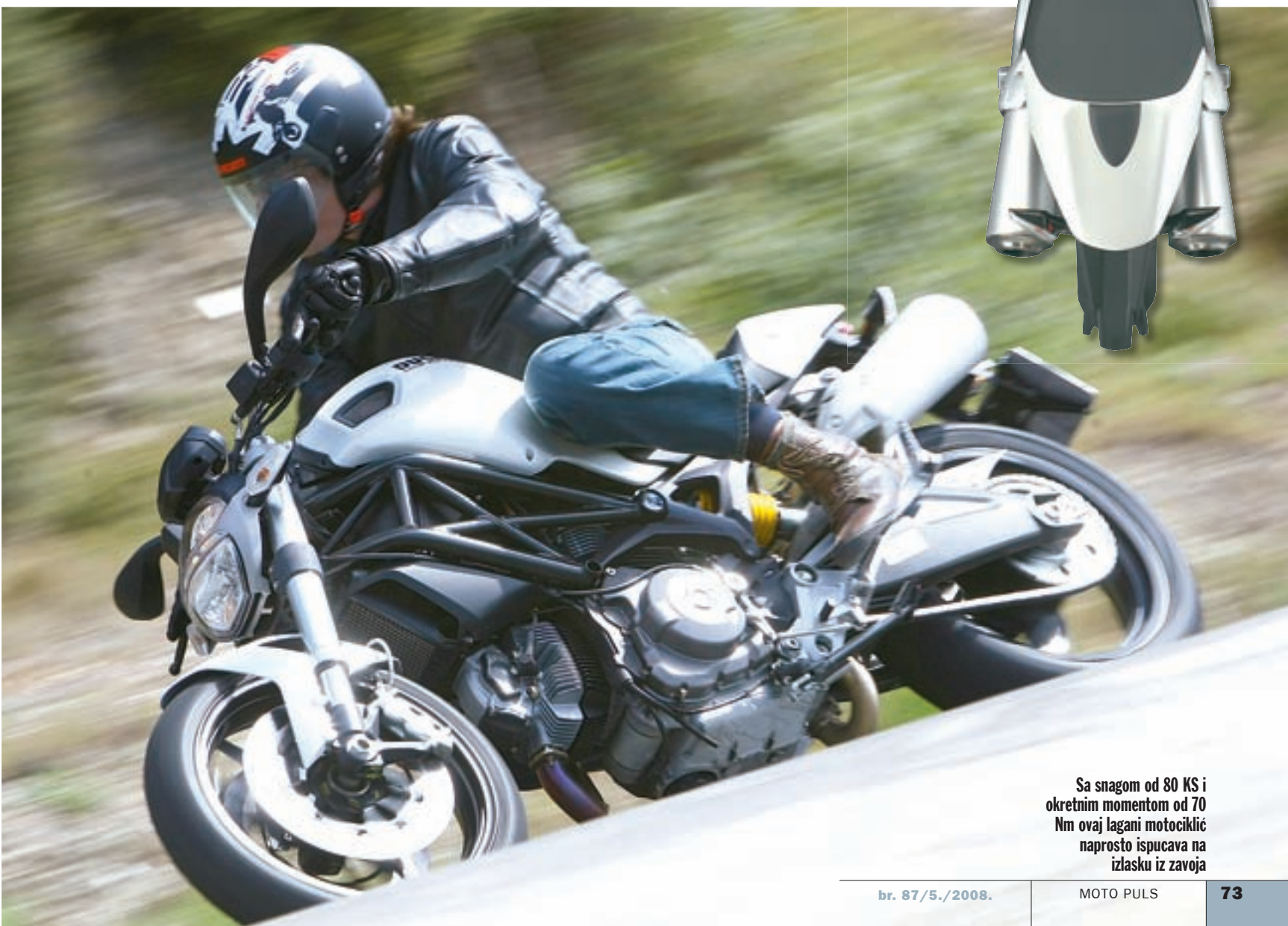
Nosive grede cjevastog okvira nešto su većeg promjera, ali su stjenke tanje, te je tako povećana čvrstoća i smanjena težina. Zadnja vilica sada je novog oblika, pojačana, aluminijska, izrađena u die-cast tehnologiji, a novi je i aluminijski nosač sjedala
