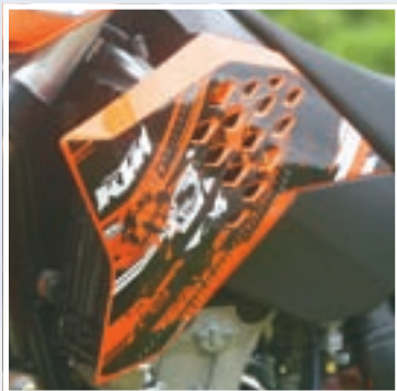
Plastične oplate za 10 mm su uže nego na dosadašnjim modelima, što poboljšava ergonomiju
