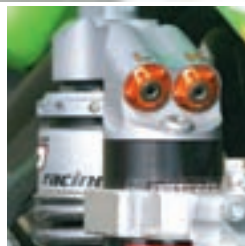
WP stražnji amortizeri s hidrauličkim upravljanjem
