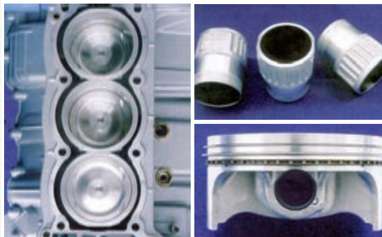
"Mokri" cilindri uprešani su u blok motora oko kojih cirkulira rashladna tekućina. Presvučeni tvrdim kromom garantiraju dugi vijek eksploatacije. Sasvim dolje vidimo moderan klip s velikim prostorom gdje je olakšan i osovinicom od čak jednog inča (25,4 mm)
