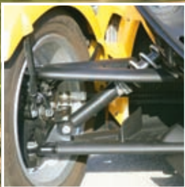
Prednji ovjes s dvostrukim poprečnim ramenima omogućava vozne osobine koje se nalaze negdje na pola puta između automobila i motocikla
