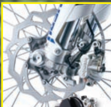
◀ Valoviti kočioni diskovi uz novo razvijena prednja plutajuća klijesta marke Brembo znače da je težina manja, a snaga i doziranje kočnica bolje
