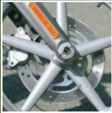
◀ Jedan neveliki disk na prednjem kotaču odlika je laganih enduro i teških H-D motocikala
