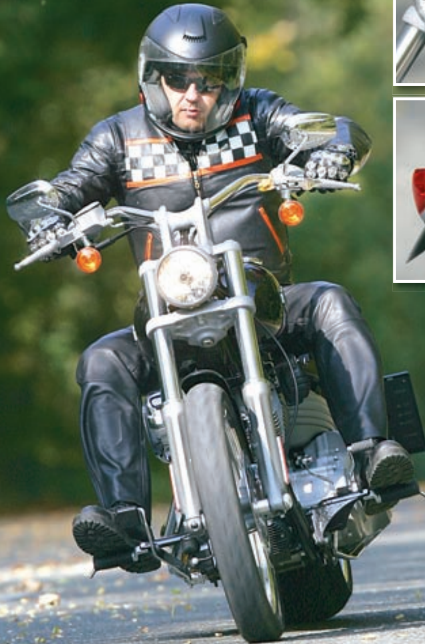
◀ Jedan neveliki disk na prednjem kotaču odlika je laganih enduro i teških H-D motocikala
