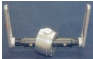
Bimota "Tesi", prednja glavčina koja demonstrira skretanje i nagib prednjeg kotača. Na slici desno gore je prednja dvostruka vilica, dok je na slici dolje prikazan složeni mehanizam upravljanja
