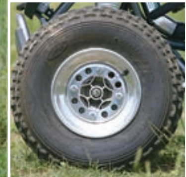
Gume su nešto većeg vanjskog promjera koji iznosi 22 cola, a to prilikom terenske vožnje pozitivno utječe i na udobnost i na prohodnost
