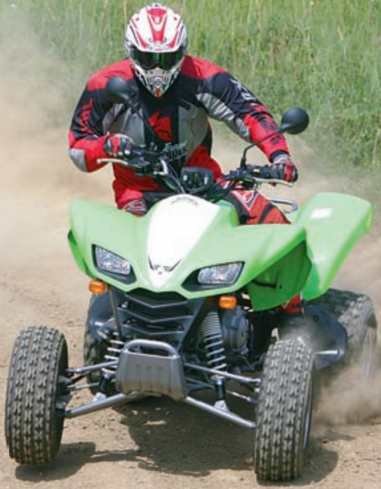
KFX ima relativno visoko težište, tako da je normalno da kod bržeg prolaska zavojima dolazi do blagog podizanja unutarnjih kotača
